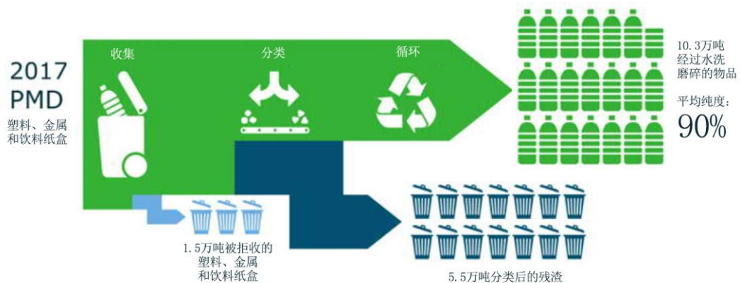
图 4 消费后塑料废弃物的收集和回收。PMD 为塑料、金属和纸基复合包装的缩写，图改编自 Brouwer 等人 (2019 年)
